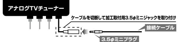
⚠ 車両側ケーブルを切断加工して取り付けます。
