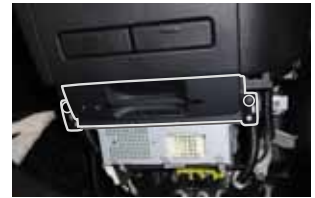
図4 AVユニットカバー取り外し
