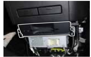
図4 AVユニットカバー取り外し
