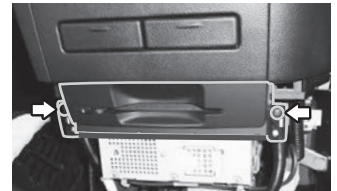
図4 AVユニットカバー取り外し
