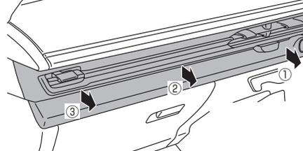
9-2. ハザード・スイッチコネクターとプッシュ・ボタン・スタート・コネクターを外し、助手席側デコレーションパネルを取り外します。
