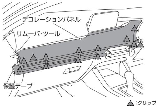
①・②・③・④の順にクリップを取り外して、助手席側デコレーションパネルを取り外します。
