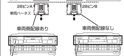
※車両ハーネス側28ピンAコネクターの上段には配線があります。(車両の仕様により配線数が異なります。)
