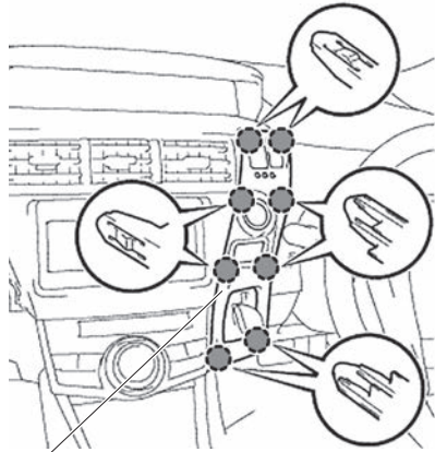
コントロールパネル
