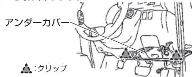
3 スクリューを外してクリップを浮かせ、ロアパネルを取り外します。
