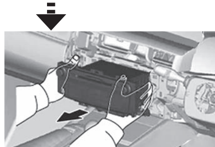
ツメとクリップを浮かせ、マルチメディアモジュールレシーバーを取り外します。
