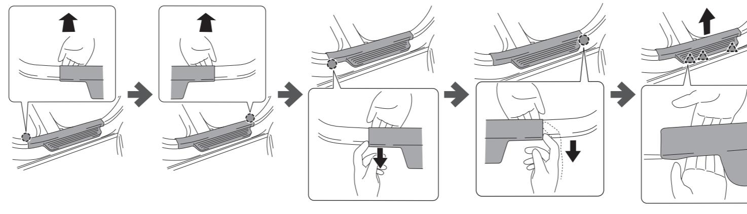
**10. 助手席足元のカバー内側にある図で示したコネクターを引き抜く**
