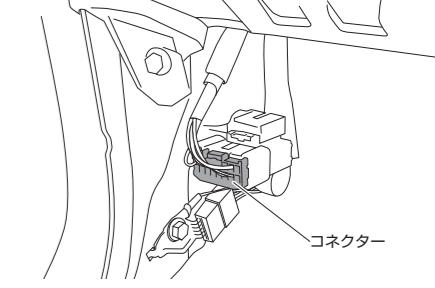
**11. ドアハーネスを固定しているクリップ2か所のかん合を外し、助手席側のゴムブーツの両端を車体から引き出す**
