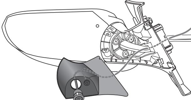
**7-8** サイドカメラキットの配線(3本)の長さを調整しながらベースカバーを取り付ける
