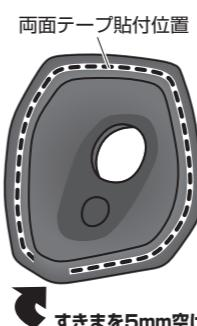
8. サイドカメラのケーブルをカメラカバーの穴に通す
