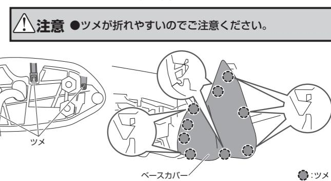
9-3 取り外したベースカバーの図で示した位置に6φの穴を開ける
