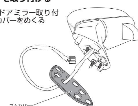
9-2 左図で示したツメ3か所のかん合を外し、ベースカバーを浮かせ、すき間にクリップリムーバーを差し込み徐々に浮かせてベースカバーを取り外す
