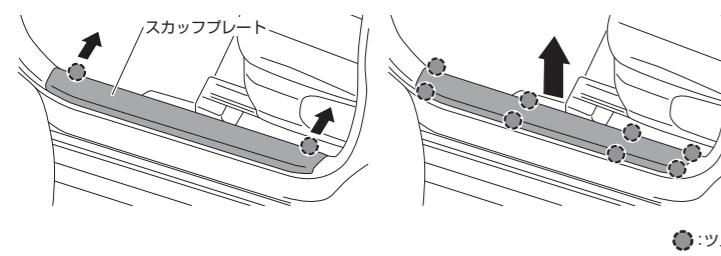
**9-2** 樹脂ナットを取り外し、クリップのかん合を外して助手席足元のカバーを取り外す
