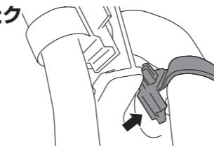
**12.** 助手席側ドアのゴムブーツの両端を外してゴムブーツを手前に引き出す
