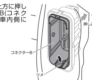
12-3 コネクターBの図で示した枠内に6φの穴を開ける
