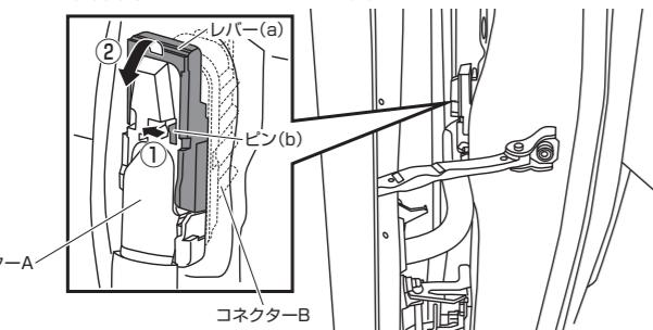
12-2 図で示したツメを上方に押ししながらコネクターB(コネクターAの相手側)を車内側に押し込み外す
