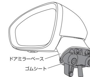
8-4 図を参考に、サイドカメラのケーブルをドアミラーベースに通す
