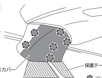
5-2 ドアミラーコネクターを切り離し、ドアミラーハーネスを固定しているクリップを外し、ドアスクリーンの図で示した部分をめくり、ボルト3本を外してドアミラーを取り外す
