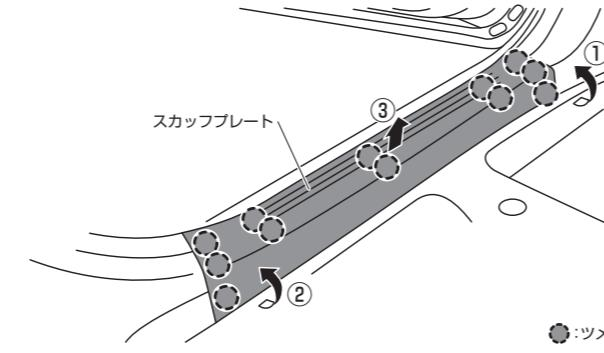
11-2 樹脂ナットを取り外し、クリップのかん合を外して助手席足元のカバーを取り外す
