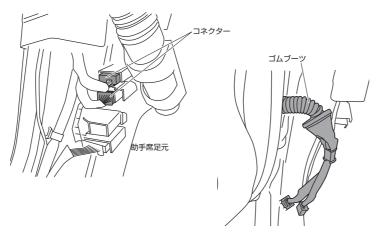
13 ゴムブーツ(ドア側)を引き出し、ドア内、ゴムブーツ、車内の順にサイドカメラのケーブルを通したあと、ゴムブーツとドアスクリーン・スピーカーを元に戻す
