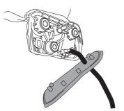
8-4 図を参考に、サイドカメラのケーブルをドアミラーベースに通す
