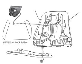
**8-5** サイドカメラのケーブルの長さを調整しながらドアミラーベースカバーをドアミラーベースに近づけ、ドアミラーベース のゴムシートを元に戻してビニールテープを元通りに巻く
