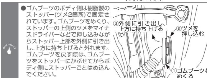
●ゴムブーツのボディ側は樹脂製のストップバー(ツメ2箇所)で固定されています。ゴムブーツをめくり、ストップバーの上側のツメをマイナスドライバーなどで押し込みながらストップバー上部を外側に引き出し、上方に持ち上げると外れます。ゴムブーツを戻す際は、ゴムブーツをストップバーにかぶせてからボディ側にストップバーごとはめ込んでください。
