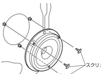
●スピーカーを元に戻す際は、スピーカーを固定しているスクリューの受け(樹脂)3個をドアから外し、スピーカーを取り付け、スクリューで固定してからスピーカーごとドアに差し込んでください。
