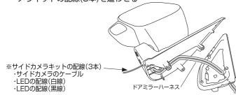
**7-6** カメラカバーがドアミラーベースに近づくまでサイドカメラキットの配線(3本)を調整してからドアミラーベースリッドを 元に戻し、ドアミラー本体にドアミラーベースを取り付ける
