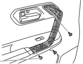
3-3 ドアアームレストとドアパネルの間に保護テープを貼り、ドアアームレストを上方に持ち上げて取り外す
