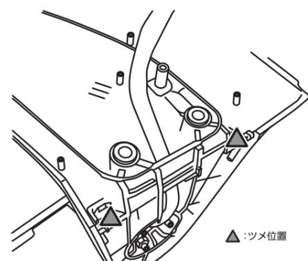
8-3 本書の型紙を切り取り、ドアミラーベースカバーに貼り付け、型紙の穴に合わせてドアミラーベースカバーに20φの穴をあける
