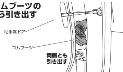
**12.** サイドカメラのケーブルを純正ドアハーネスに沿って這わせ、数か所を結束バンドで固定しながらゴムブーツに通して車内に引き込む
