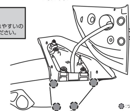
▲で示した位置にあるドアミラーベースカバーのツメ2箇所を押しながらかん合を外し、ドアミラーベースカバーの手前側を浮かせる
