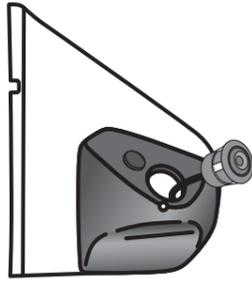
**8-7** サイドカメラのケーブルを、ドアミラーの純正ハーネスに沿わせながらドアミラー内側から外側に引き出す
