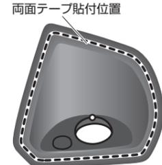
7. サイドカメラのケーブルをカメラカバーの穴に通す
