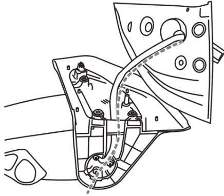
**8-8** サイドカメラのケーブルの長さを調整しながらドアミラーベースカバーをドアミラーに取り付ける
