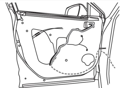
**14.** 車両のイルミネーション線に、LED制御ユニットの橙線を接続する
