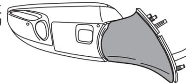
**9-2** 本書左下の型紙を切り取り、ベースカバー内側に貼り付け、型紙の穴に合わせて、ベースカバーに20φと10φの穴をあける
