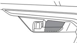
**3-2** キズがつかないように保護してから矢印の位置に内張はがしを差し込み、ドアアームレストのパネルを取り外す
