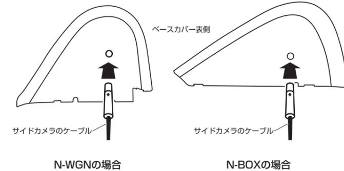
**8-7 ドアミラーベースカバーを元に戻し、台座のゴムカバーの穴にサイドカメラのケーブルを通す。ドアミラーのハーネスにサイドカメラのケーブルを付属の結束バンドで固定する**
