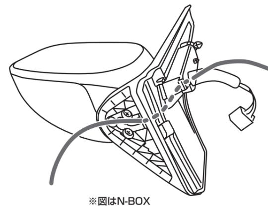
**10. 図で示したコネクターを外して、ゴムブーツ(室内側)を引き出す**
