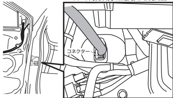
14. 樹脂製のホールカバーのツメ4か所を、保護テープを巻いたマイナスドライバーを使用しボディ内側から押し込み、ゴムブーツをドアハーネスごと引き出す
