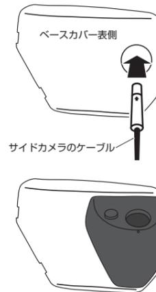
**10-5** サイドカメラのケーブルを図のようにドアミラーベース内に通す
