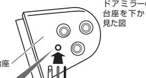
**7-3 項目「7-2」で拡大した穴に、サイドカメラのケーブル、LEDの配線(白線/黒線)の順に通す**
