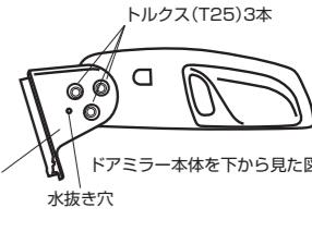
**7-5 カメラカバーが台座に近づくまで配線を調整してから項目「7-1」で外したトルクスを使用して、台座にドアミラー本体を取り付ける****①重要**
