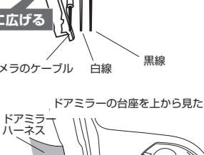
**7-4 台座のゴムカバーをめくり、横穴(ドアミラーハーネスが通っている穴)に、サイドカメラキットの配線(3本)を通す**
