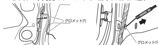
12. コードクリップおよび結束バンド(黒)を使用して、サイドカメラのケーブルを固定する
