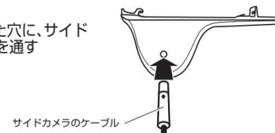
7-5 ドアミラーの横穴(ハーネスが通っている穴)に、サイドカメラのケーブルを通す
