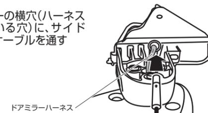
7-6 カメラカバーが取り付けできる位置まで、配線の長さを調整する
