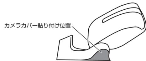
7-9 カメラカバーに貼り付けた両面テープの保護シートをはがし、カメラカバーをドアミラーに固定する
