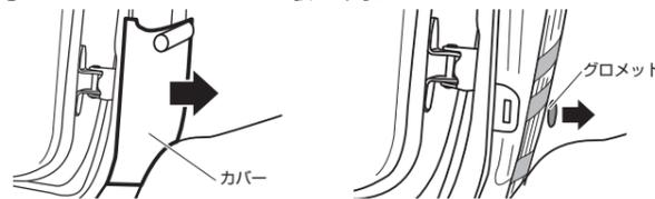
11. 下側ドアヒンジ上方にあるグロメットを取り外し、サイドカメラのケーブルをグロメットの穴から入れ、車内側のグロメットを外した穴に通す
