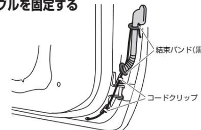
13. ケーブルの長さを調整し、グロメットをボディに取り付ける
