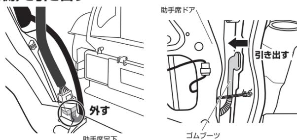
**10.** ゴムブーツ(ドア側)を外し、ドア内、ゴムブーツ、車内の順にサイドカメラキットの配線(3本)を通したあと、ゴムブーツと外したコネクターを元に戻す
