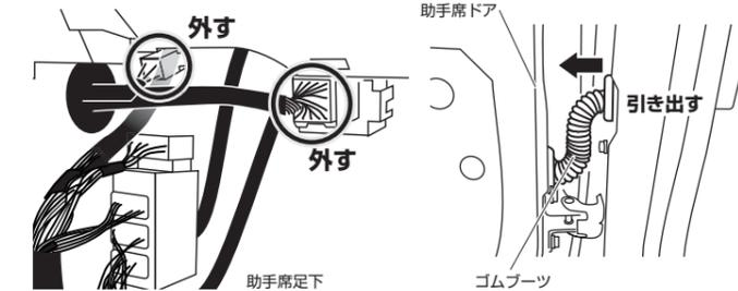
11. ゴムブーツ(ドア側)を取り外し、ドア内、ゴムブーツ、車内の順にサイドカメラキットの配線(3本)を通したあと、ゴムブーツを元に戻す
