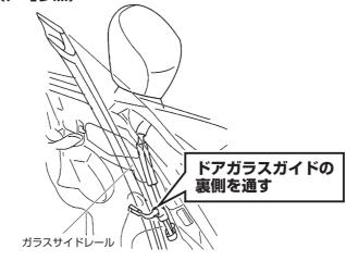
●ドアミラーのハーネスは、ドアガラスガイドの裏側を通 してください。正しく通さないと、ドアガラス開閉時に ハーネスを損傷させるおそれがあります。
