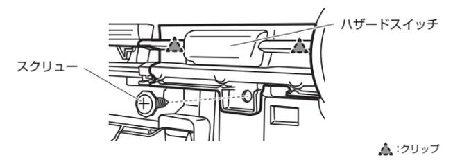
**14-3** ハザードスイッチ(4ピンコネクター)のイルミネーション線に、LED制御ユニットの橙線をエレクトロタップで接続する
