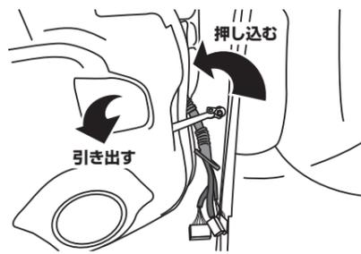
**12. サイドカメラキットの配線をゴムブーツに通してからゴムブーツを元に戻し、項目「10.」で外したコネクターを接続する**
