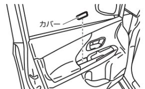
3-4 ドアの左右にテーピングをしてから、スクリュー、ドアパネルの順で取り外す
