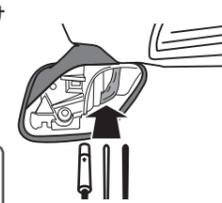
7-5 純正のドアミラーカバーをドアミラーに取り付けたあと、車両にドアミラーを取り付ける(項目「4.」参照)
