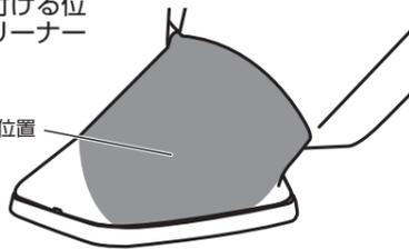
7-7 カメラカバーに貼り付けた両面テープの保護シートをはがし、ドアミラーのカバーにカメラカバーを固定する
