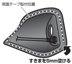
6. サイドカメラのケーブルをカメラカバーの穴に通す
