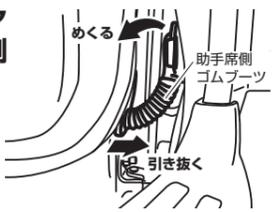
**13.** ゴムブーツ取り付け部のツメを押してロックを外し、ホルダーカバーを取り外す
