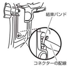
**12.** 助手席側ゴムブーツのドア側を引き抜き、ボディ側をめくる
