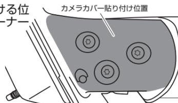
**7-8** カメラカバーに貼り付けた両面テープの保護シートをはがし、カメラカバーと台座を固定する
