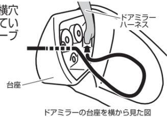
**7-5** カメラカバーが取り付けできる位置まで、配線の長さを調整する
