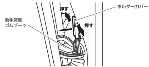
**14.** サイドカメラのケーブルを、助手席側ドア、ゴムブーツの順に通して、車内に引き込む
