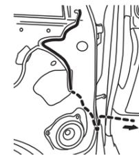
**15.** 助手席のドアを半開きにして、ホルダーを手前に引き出してから、ホルダーカバーを取り付ける
