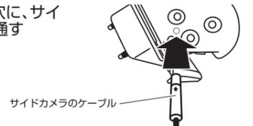
**7-4** 台座のゴムカバーをめくり、横穴(ドアミラーハーネスが通っている穴)に、サイドカメラのケーブルを通す
