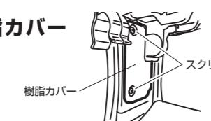
10. 樹脂カバー取り付け部の奥にあるコネクターを2個引き出して切り離す
