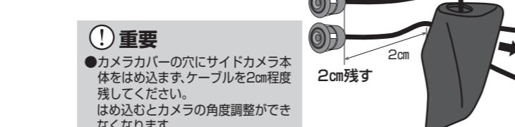
14. サイドカメラのケーブル2本を、助手席側ドア、ゴムブーツの順に通して、車内に引き込む
