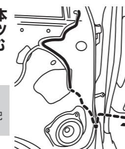
15. 助手席のドアを半開きにして、ホルダーを手前に引き出してから、ホルダーカバーを取り付ける
