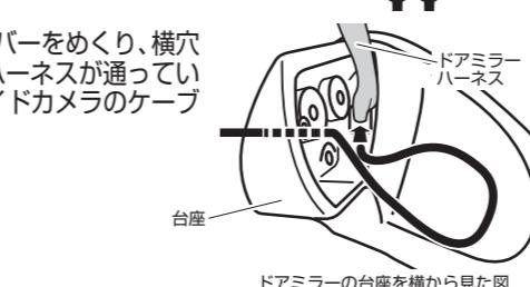
7-5 カメラカバーが取り付けできる位置まで、配線の長さを調整する
