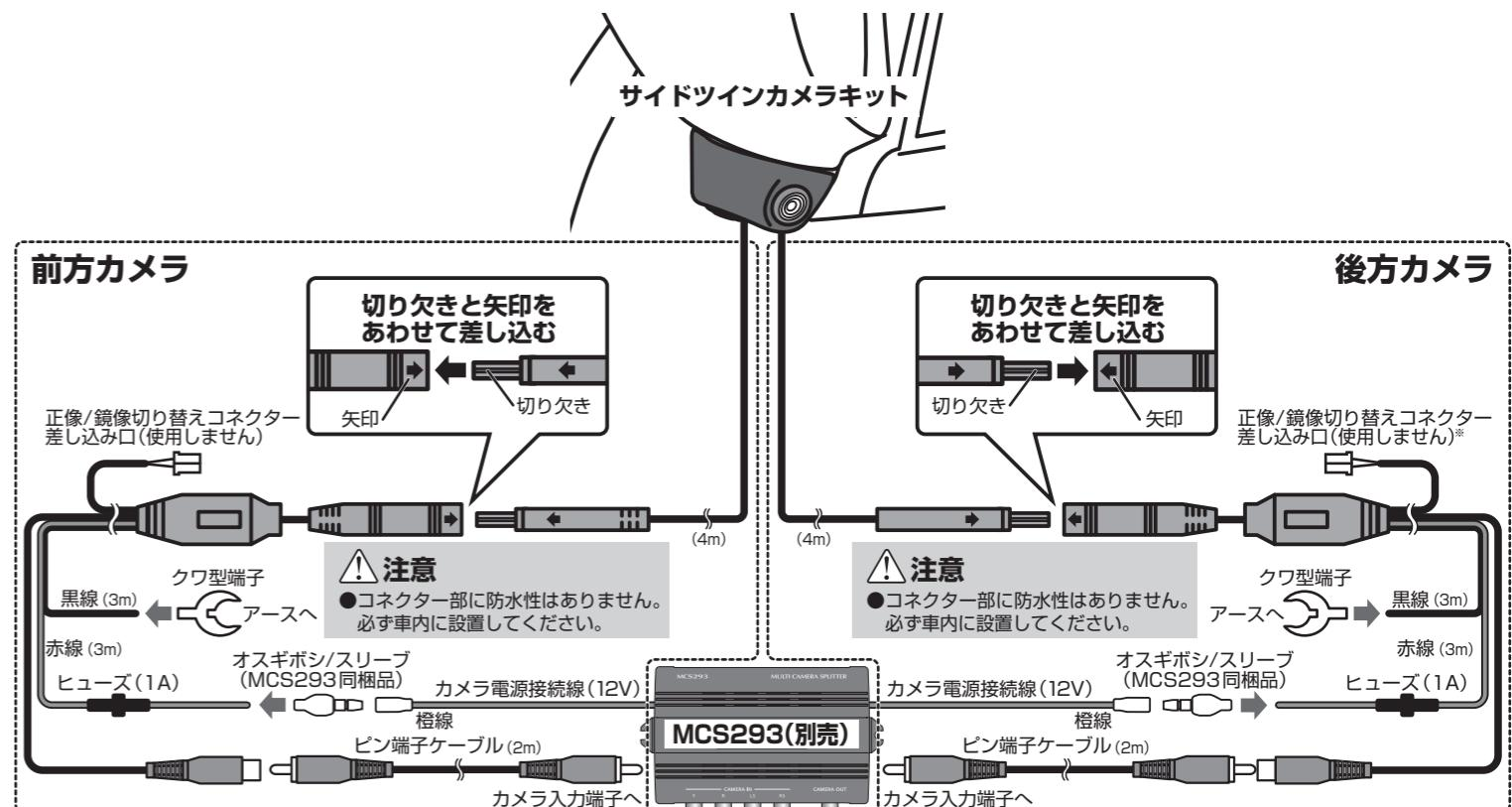
※右図のように、後方カメラの映像をドアミラーの映りに合わせたい場合は、正像/鏡像切り替えコネクターを差し込み、カメラを180°回転させてください。
