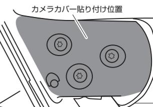
7-8 カメラカバーに貼り付けた両面テープの保護シートをはがし、カメラカバーと台座を固定する
