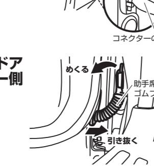
13. ゴムブーツ取り付け部のツメを押してロックを外し、ホルダーカバーを取り外す
