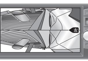
26. サイドツインカメラの映像が右図のように映るよう、前後のカメラを回転させて調整する
