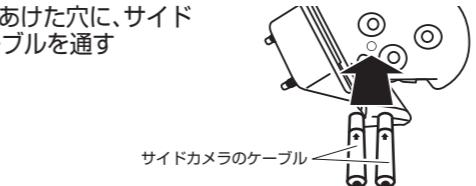
7-4 台座のゴムカバーをめくり、横穴(ドアミラーハーネスが通っている穴)に、サイドカメラのケーブルを通す
