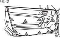
**\\\\ ☆**:クリップ **3-4** ドアパネルのドアロックワイヤーを取り外す
