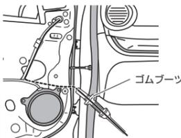
**13. ゴムブーツを元に戻して、外したコネクター3個を接続する**
