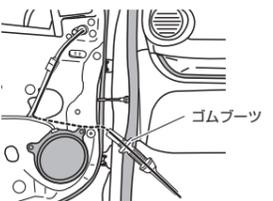
**13. ゴムブーツを元に戻して、外したコネクタ3個を接続する**
