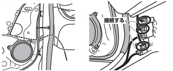
**14. オーディオユニット裏のイルミネーション線に、LED制御ユニットの橙線を接続する**
