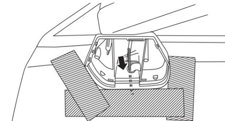
5-2 ドアスピーカー取り付け部から手を入れ、カメラケーブルのコネクターを引っ張りカメラケーブルをドア内に引き込む
