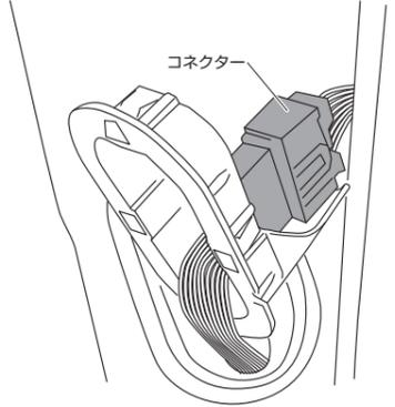
**6-4** ストッパーが付いたコネクタの図で示した位置(上側の四角い穴)に細長いマイナスドライバーを差し込み、奥にあるツメを押し下げてかん合を外し、コネクタからストッパーを取り外す
