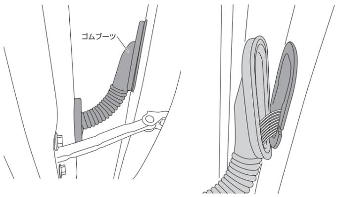
**6-2** ストッパーを外側に引き、手前及び上部のツメを押し込み、外側に引いて引き出す
