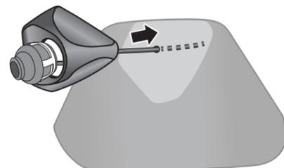
4-6 ドアミラーベースカバーにカメラカバーを仮合わせて、カメラカバー貼り付け位置を確認する
