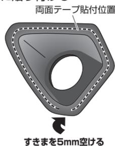
4-4 ドアミラーベースカバーのカメラカバー取り付け位置周辺の汚れを付属の脱脂クリーナーでふき取る
