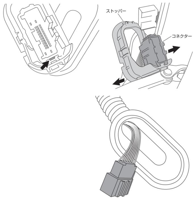
**6-5** ドア側ゴムブーツを外し、ゴムブーツをドア内に押し込みスピーカー取り付け部から引き出す
