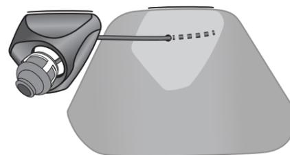
4-7 カメラカバーに貼り付けた両面テープの保護シートをはがし、カメラカバーをドアミラーベースカバーに貼り付ける
