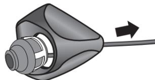
4-3 取り外したドアミラーベースカバー内側の図で示した位置に6.5φの穴を空ける
