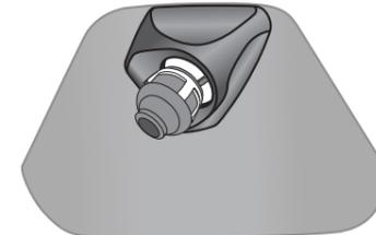
4-8 カメラケーブルを引き、カメラ本体がカメラカバーに当たる程度まで調整する
