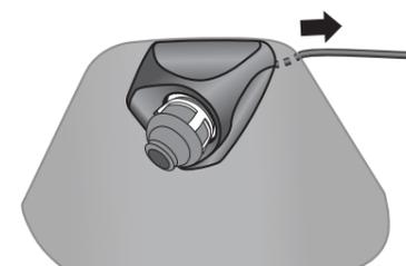
4-2 サイドカメラのケーブルをカメラカバーの穴に通す
