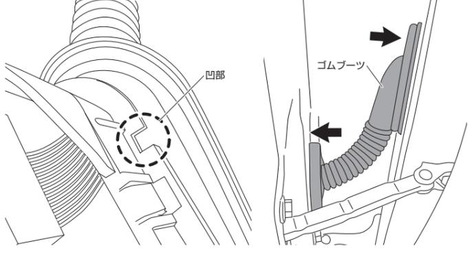
**6-8** カメラケーブルを下図のとおり這わせ、カメラケーブルがドア内でたるまなくなるまで車内側から引き、結束バンドで数か所を純正ハーネスに固定する
