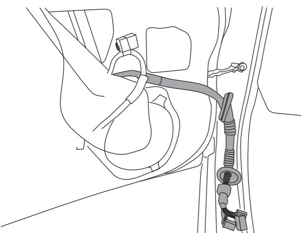
●ゴムブーツにストッパーをかぶせる際は、ゴムブーツ内側の凸部とストッパーの切り欠き部を合わせてください。
