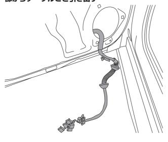
12. サイドカメラのケーブルを純正ドアハーネスに沿って這わせ、数か所を結束バンドで固定しながらゴムブーツに通して車内に引き込む
