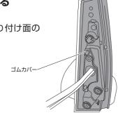
**7-2** 矢印で示したツメのかん合を外してベースカバー手前を 浮かせ、すき間にクリップリムーバーを差し込み徐々に浮 かせてベースカバーを取り外す
