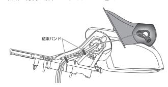
**7-8** サイドカメラのケーブルの長さを調整しながらベースカバーをドアミラーに取り付ける
