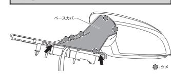
7-3 本書表面左下の型紙を切り取り、ベースカバー外側に貼り付け、型紙の穴に合わせて、ベースカバーに20 φの穴をあける
