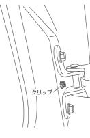
ゴムブーツの両端を引き抜き、スピーカー取り付け 部からケーブルごと引き出す
