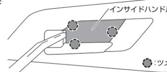
1-2 パワーウィンドウスイッチASSYの周囲に保護テープを貼り、クリップリムーバーを使用して上方に持ち上げてツメとクリップのかん合を外し、裏側のコネクタを切り離して取り外す
