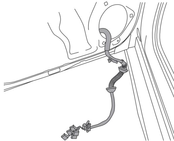
**12.** サイドカメラキットの配線(3本)を純正ドアハーネスに沿って這わせ、数か所を結束バンドで固定しながらゴムブーツに通して車内に引き込む
