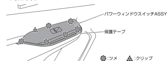
1-3 クリップリムーバーを使用してパワーウィンドウスイッチASSY横にあるドアトリムボードのツメ2箇所のかん合を外して押し下げる
