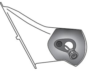
7-7 サイドカメラキットの配線(3本)を、ドアミラーの純正ハーネスに沿わせながらドアミラー内側から外側に引き出し、図で示した2箇所が付属の結束バンドをゆるめに巻く
