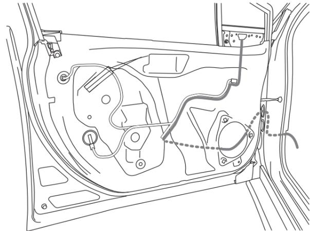
**13.** 車両のイルミネーション線に、LED制御ユニットの橙線を接続する
