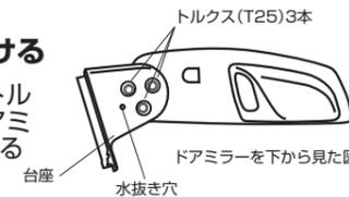
**7-2** 台座の付け根にある水抜き穴を6φに拡大する
