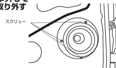
**12. ゴムブーツ(ドア側)を取り外し、ドア内、ゴムブーツ、車内の順にサイドカメラのケーブルを通したあと、ゴムブーツとスピーカーを元に戻す**
