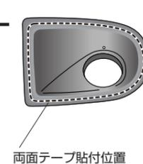
**6. サイドカメラのケーブルをカメラカバーの穴に通す**
