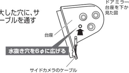
**7-4** 台座のゴムカバーをめくり、横穴(ドアミラーハーネスが通っている穴)に、サイドカメラケーブルを通す
