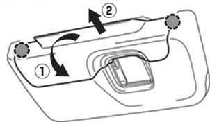
1-2. カバーを下方に引き、フロントセンシングカメラカバー(下)を取り外す。
