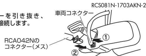
5. 「4.」で外した車両側のコネクタに付いているコネクタのカバーを外し、RCA042Nのコネクタ(オス)を接続します。
