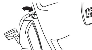
7. 接続概要図を参照して、本製品のRCAケーブルをヘッドライニング、Aピラーに沿って引き直し、ナビゲーション裏まで通して接続します。
