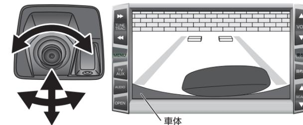
8-3 カメラ本体をカメラカバーに差し込みます。カメラの向きを微調整します。
