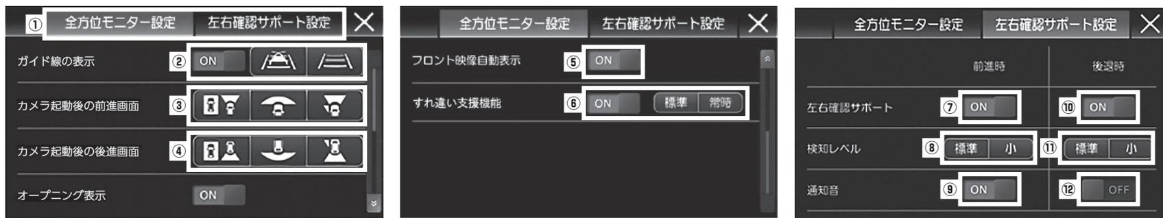
**重要** 初めて設定を行う時は、「カメラ起動後の前進画面」と「カメラ起動後の後退画面」を手動で選択してください。この項目を選択しないと、カメラ映像が正しく表示されません。(一度設定すれば、2回目以降は不要です)
