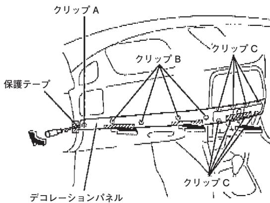
手順 1 図の位置に傷防止に保護テープを巻いたリムーバ等を差し込み、矢印の方向へ動かしてクリップAを取り外す
