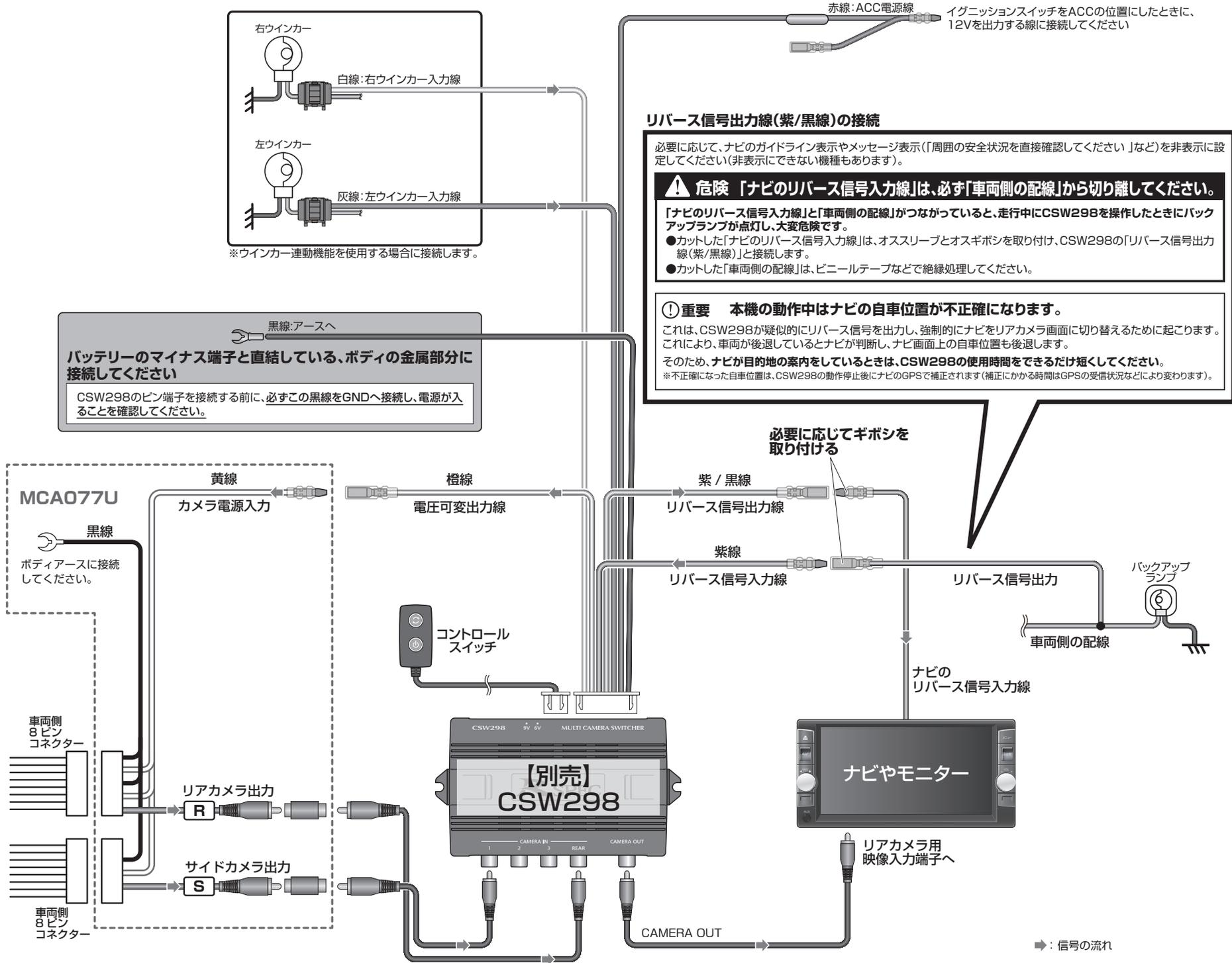
1. CSW298の電圧切り替えスイッチを「6V」に設定してください。それ以外の電圧に設定した場合、純正カメラが故障するおそれがあります。
