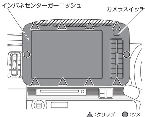
スクリューをはずし、図示の斜線部に手を掛けて手前の方向に引き、インパネセンターガーニッシュのベースを取り外す。
