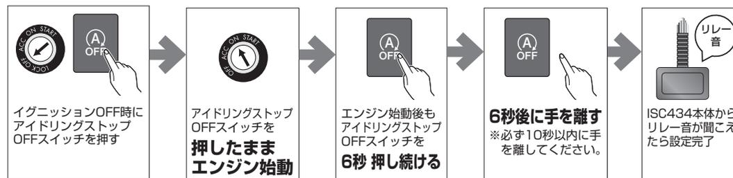
**重要** ●リレー音は、アイドリングストップキャンセルモード→純正モードに変更の際には「カッチ」、純正モード→アイドリングストップキャンセルモードに変更の際には「カッチ カッチ」と鳴ります。
