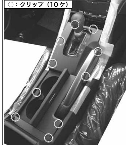
灰皿とアームレストの蓋を開ける。周囲のクリップ勘合を浮かせてセンターコンソールパネルを外す。
