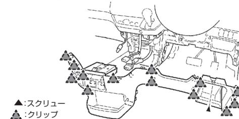
**注意** 「4. センターパネル取り外し」のボルトが外せる程度、手前に引き出します。
