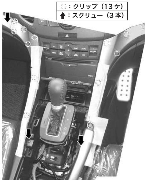
図示のスクリュー (3本) を抜いて、周囲のクリップ (13ヶ) 勘合を浮かせて、ガーニッシュを取り外す。
