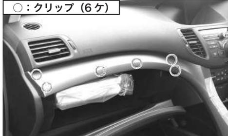
図示のクリップ勘合を浮かせてガーニッシュを外す
